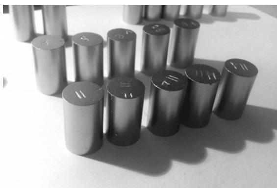
Рисунок 11 – Фотография изготовленных образцов сплава Fe-Cr-Co
